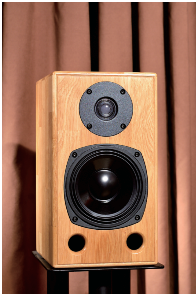
Joy音箱技术规格： ■ 系统：2路2单元低音反射式 ■ 中低音单元：AudioBarletta 150mm ■ 高音单元：AudioBarletta 26mm ■ 频率响应(-3dB)：55Hz-20kHz ■ 阻抗：8Ω ■ 分频点：3500Hz ■ 灵敏度(2.83V/1m)：85dB ■ 推荐放大器功率：30-140W ■ 体积：305×170×200 (mm) ■ 净重(1件)：6.9kg ■ 连接：1对香蕉插头端子
