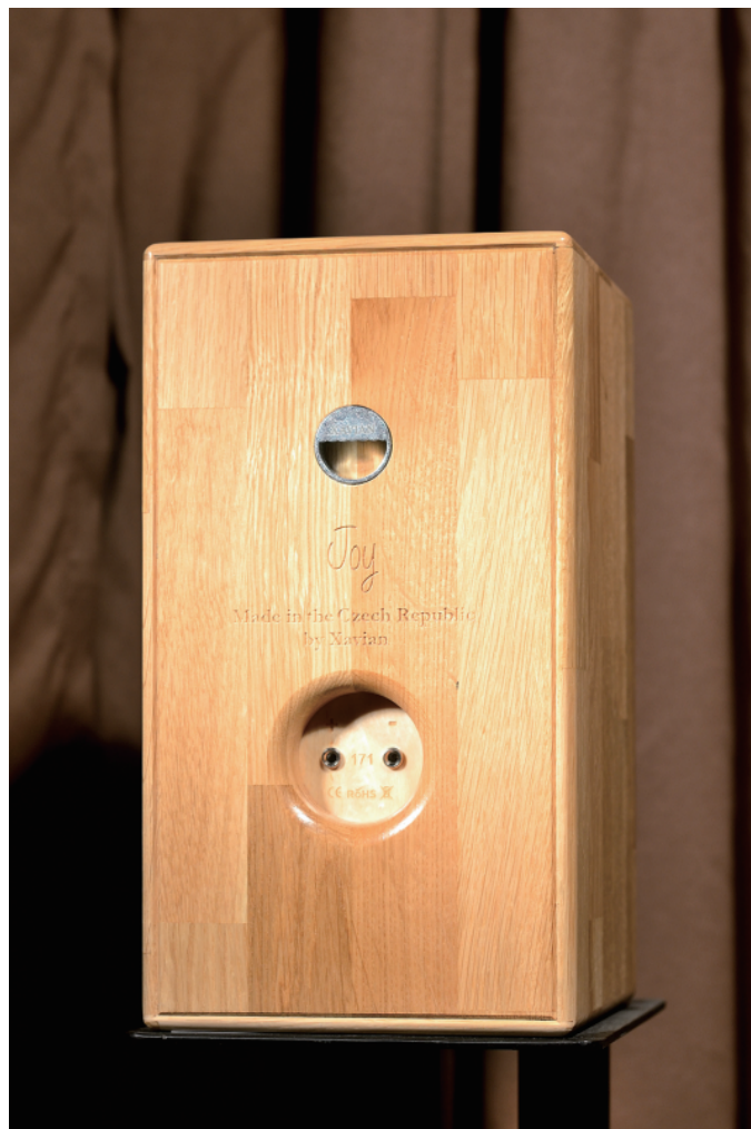
Joy音箱技术规格： ■ 系统：2路2单元低音反射式 ■ 中低音单元：AudioBarletta 150mm ■ 高音单元：AudioBarletta 26mm ■ 频率响应(-3dB)：55Hz-20kHz ■ 阻抗：8Ω ■ 分频点：3500Hz ■ 灵敏度(2.83V/1m)：85dB ■ 推荐放大器功率：30-140W ■ 体积：305×170×200 (mm) ■ 净重(1件)：6.9kg ■ 连接：1对香蕉插头端子
